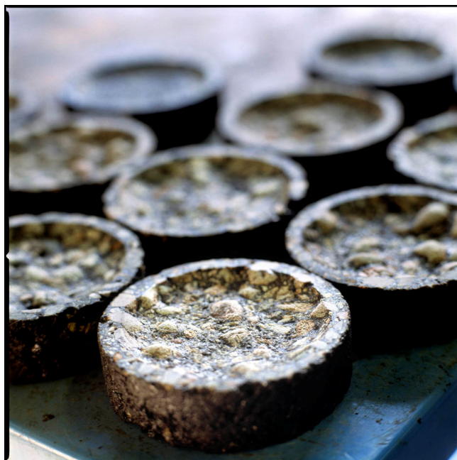
Bild 8: Provkroppar efter Prall.
